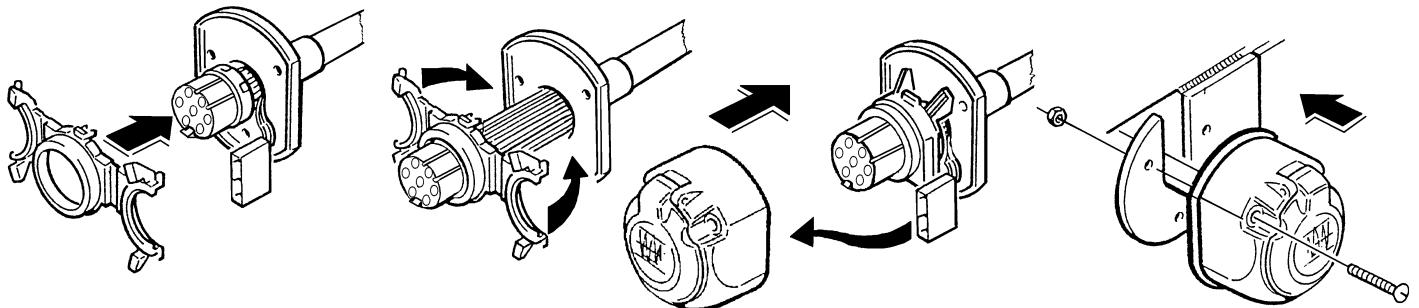
Positionner le joint de prise caoutchouc pré monté sur le faisceau sur le boîtier de prise.
