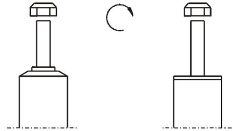
Um eine mögliche Zerstörung des Produktes zu vermeiden, darf zum Lösen und Anziehen der Muttern kein Schlagschraubendreher verwendet werden. Selbstsichernde Muttern dürfen nur einmal verwendet werden!
