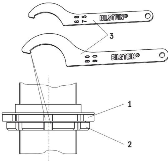
Die Sicherung von Federteller (1) und Kontermutter (2) erfolgt mit Hilfe des im BILSTEIN Lieferumfang enthaltenen Hakenschlüssels (3).
