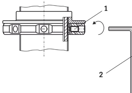
Den Federteller mit dem im BILSTEIN Lieferumfang enthaltenen Gewindestift (1) und mit Hilfe des mitgelieferten Innen-6kt-schlüssels (2) sichern.
