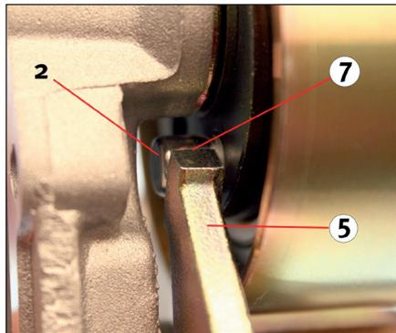
Image 3: Position de montage correcte (vue arrière)
