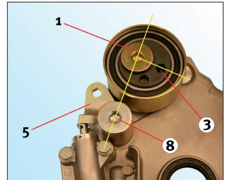
Image 4: Position de montage correcte (vue avant)
