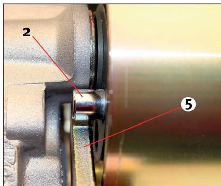
Image 5: Position de montage incorrecte (vue arrière)
