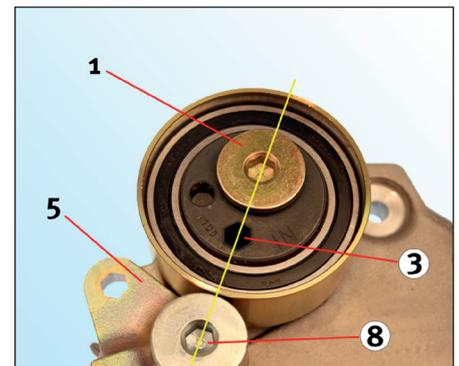
Image 6: Position de montage incorrecte (vue avant)
