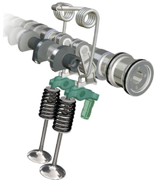
Image 1 : Présentation générale du système BMW Valvetronic
