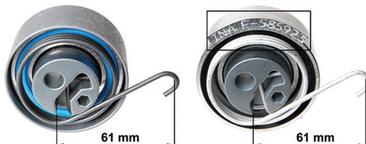
Photo 1 : réf. 531 0535 20 - A gauche, l'ancienne version, à droite, la nouvelle version
