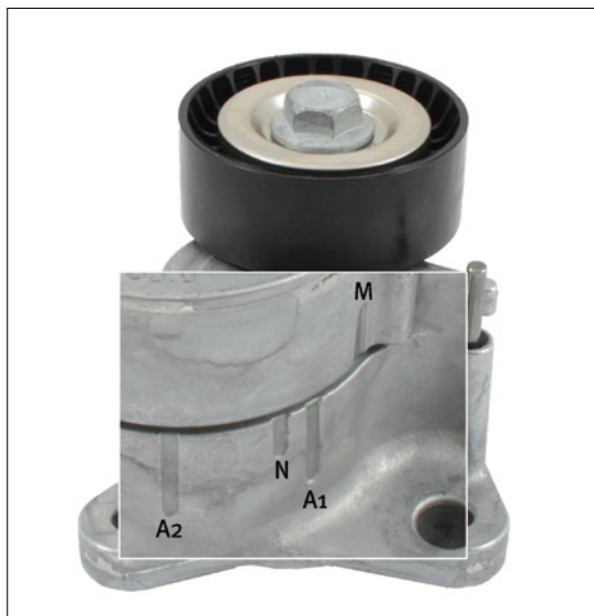
Photo 2 : Marquage modifié pour la zone de travail du bras tendeur
