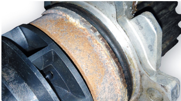
Image 1 : Traces de corrosion sur une pompe à eau
