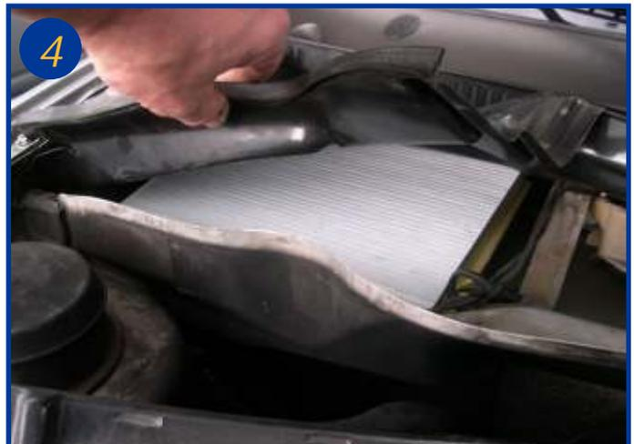
Retirer l'élément filtrant usagé et le remplacer
