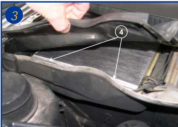
Soulever le cache protégeant le filtre (il n'est pas nécessaire de le retirer totalement).
