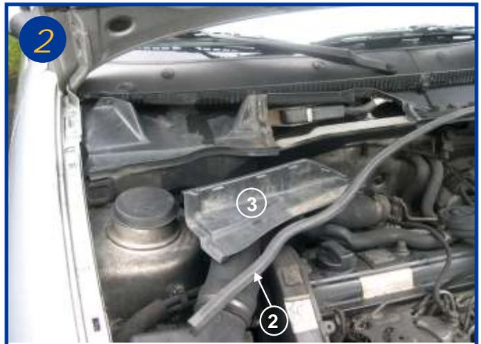
Retirer le joint d'étanchéité du compartiment moteur (2) retirer également le cache d'accès au moteur d'essuie glace (3)
