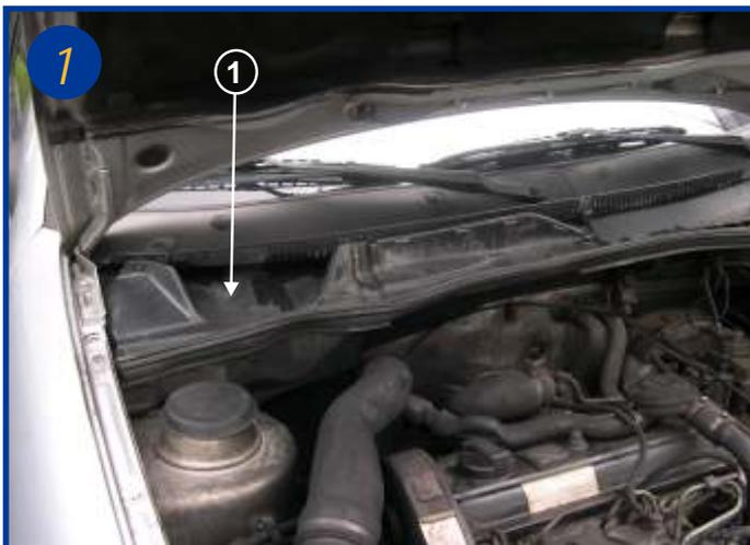
L'élément filtrant est situé sous le capot moteur coté passager sous la baie de pare brise (voir flèche 1)
