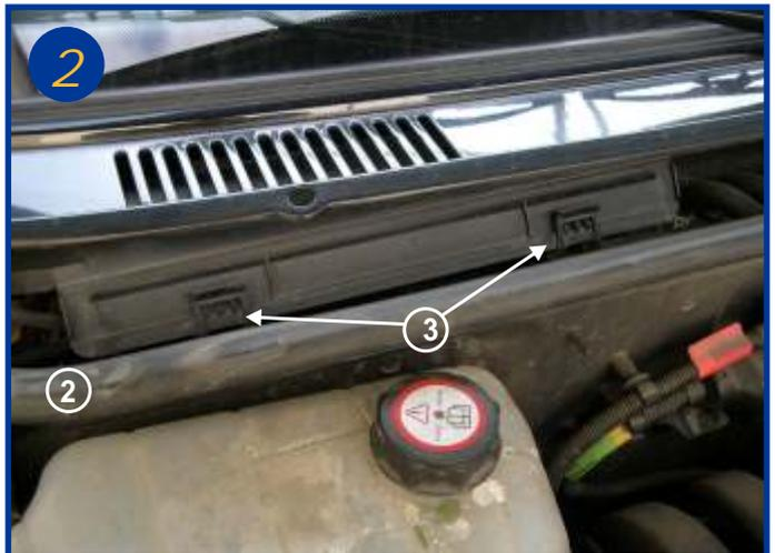
Ecarter le joint de séparation du compartiment moteur (2) pour avoir accès aux 2 fermetures (flèche 3) du volet plastique du boîtier de l'élément filtrant.
