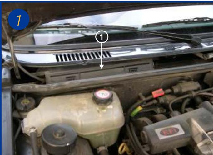
L'élément filtrant est situé sous le capot moteur sous la baie du pare brise
