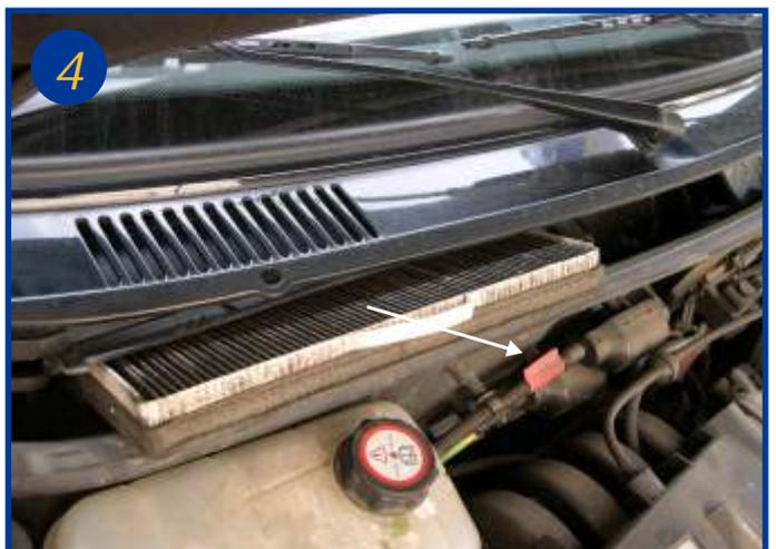
Dégager l'élément filtrant usagé (voir flèche)
