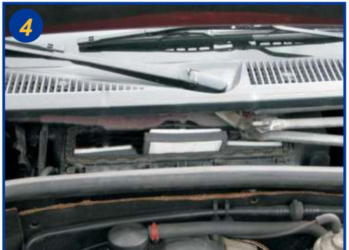
Extraire les 3 filtres usagés en commençant par celui du centre puis les 2 autres et les remplacer. Le remontage s'effectue dans l'ordre inverse du démontage.
