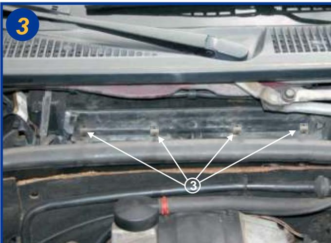
Retirer à l'aide d'un tournevis les 4 clips métalliques (3) assurant la fermeture du boîtier filtrant.
