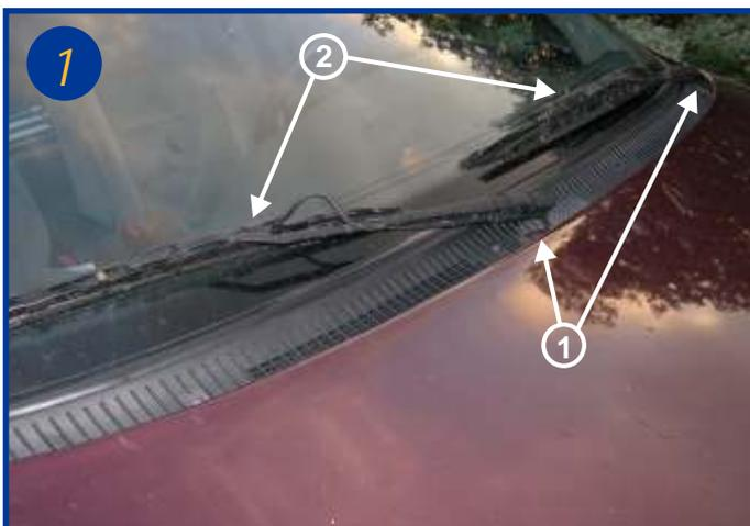
L'élément filtrant est situé dans le boîtier d'aération sous le capot moteur du côté passager. Ouvrir le capot moteur Retirer du boîtier d'aération les conduites d'arrivée d'eau de chaque essuie glace (flèche 1). Refermer le capot moteur Retirer également les 2 balais d'essuie glace (flèche 2). Ouvrir le capot moteur.
