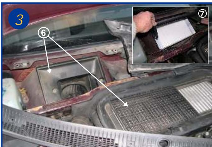
Si votre véhicule n'est pas déjà équipé d'un filtre à air habitacle, retirer la grille d'aération et le boîtier (6) et placer un cadre prévu à cet effet par Peugeot en lieu et place (7) Extraire l'élément filtrant usagé
