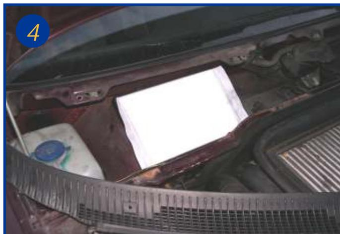
Saisir l'élément par les languettes, toute manipulation de l'élément devra être faite le joint en mousse vers le bas Assurer un bon appui avec la partie inférieure en pressant légèrement sur le joint et faire basculer l'ensemble Le remontage s'effectue dans l'ordre inverse du démontage.
