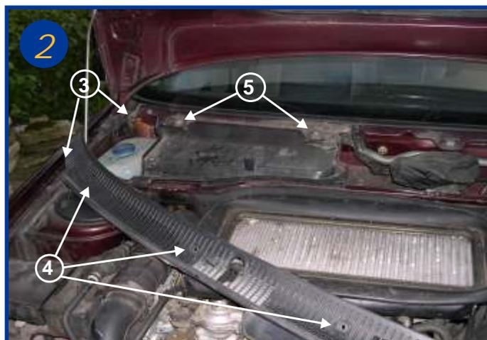
Retirer la grille d'auvent après avoir oté la pince de fixation (flèche 3) et dévissé les 3 vis cruciformes (flèche 4). Dévisser ensuite le carter du ventilateur fixé par 2 vis à empreinte Torx (flèche 5). Retirer ce carter.
