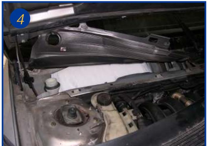
Changer l'élément filtrant usagé, le joint mousse de l'élément filtrant doit être positionné vers le bas.
