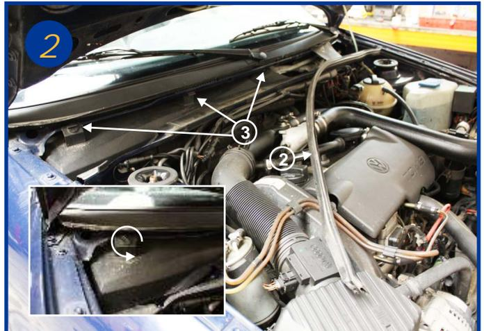
Retirer sur la moitié le joint d'étanchéité du compartiment moteur (2), puis dévisser d'un quart de tour les 3 loquets plastiques (3) (voir encadré).
