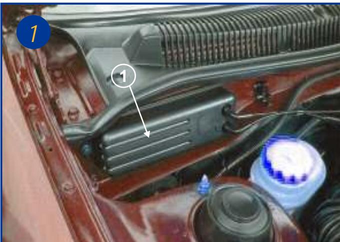
Le filtre d'habitacle est situé sous le capot moteur, coté passager sous la grille de ventilation (1).
