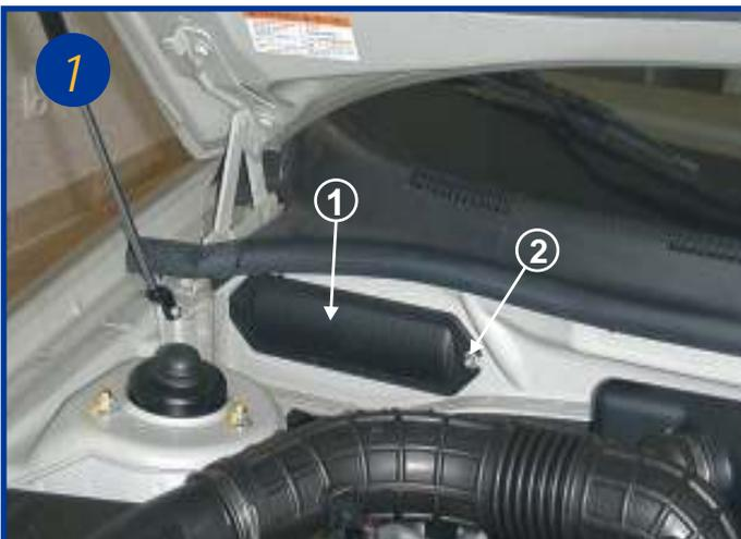
Le filtre d'habitacle est situé sous le capot moteur, côté passager sous la baie de pare-brise (1). Dévisser la vis de 8 (2).
