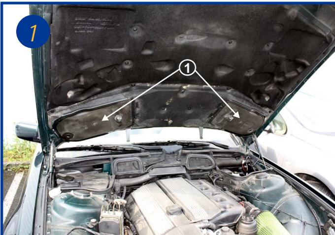
Les filtres d'habitacle sont situés sur le capot moteur (1) à gauche et à droite.
