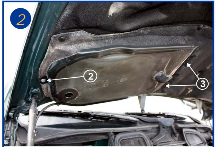
Dévisser la vis cruciforme (2) et basculer le couvercle monté sur charnière (3). Cette action est à effectuer des 2 cotés.
