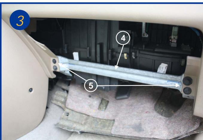
Retirer la barre de renfort (4) en dévissant 3 vis M6 et 1 vis M8 (5).
