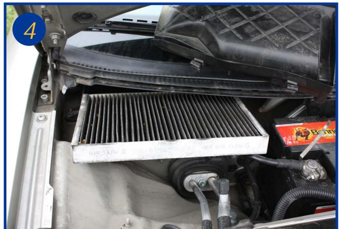
Remplacer le par un filtre neuf.
