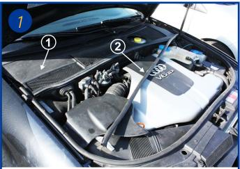
L'élément filtrant à charbon actif est situé sous le capot moteur coté passager (1).
