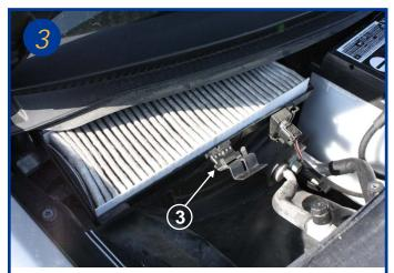
Dégager l'élément filtrant après avoir basculé le loquet de fermeture du boitier (3).
