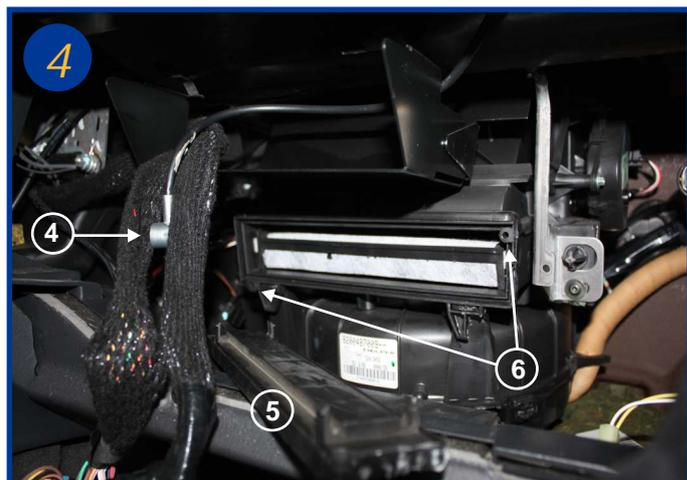
Ouvrir le couvercle du boîtier filtrant (5) à l'aide d'un tournevis ou dans certains cas en dévissant les 2 vis de 6 (6). Extraire le filtre usagé. Le remontage s'effectue dans l'ordre inverse du démontage.
