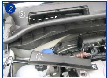
Retirer la trappe (2), le filtre à particule est alors visible dans son boitier plastique (flèche 3)
