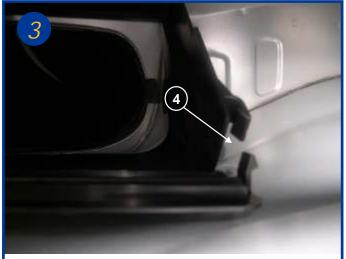
Il s'agit alors de déclipser le couvercle (flèche 4), de basculer celui-ci et de faire coulisser l'élément filtrant afin de le retirer .
