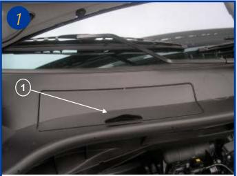
L'élément filtrant est situé sous le capot moteur coté passager sous une trappe (flèche 1)
