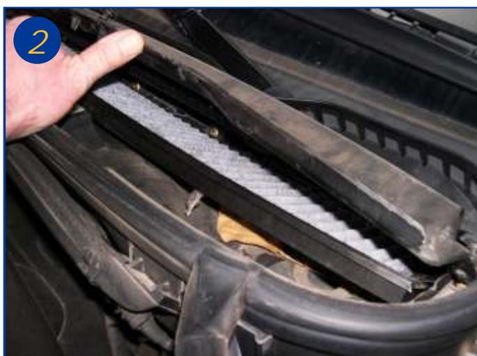
Soulever la trappe et la maintenir ouverte pour extraire l'élément filtrant
