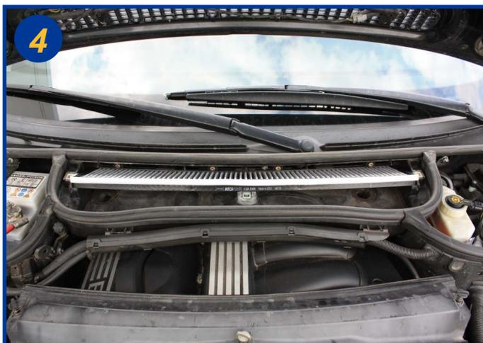
Remettre un filtre neuf en le positionnant correctement.
