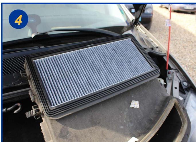
Sortir l'ensemble du support filtre. Replacer un filtre neuf en imbriquant les 2 plis d'extrémité dans les nervures prévues sur le logement. Le remontage s'effectue dans l'ordre inverse du démontage.
