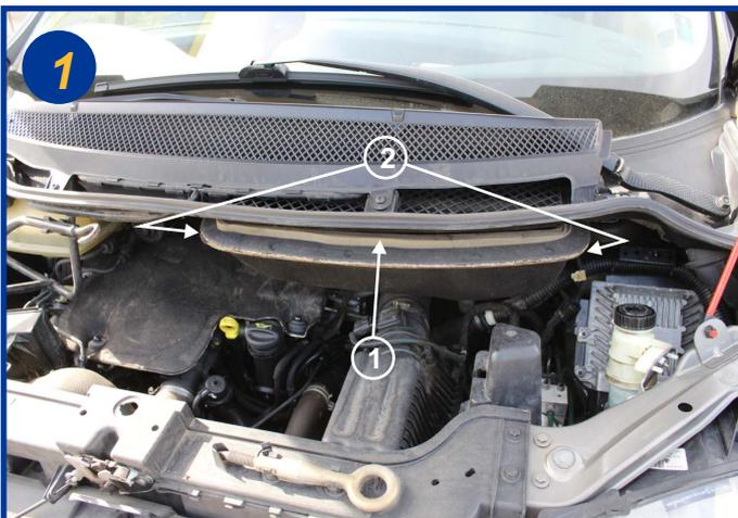
Le filtre d'habitacle est situé sous le capot moteur côté conducteur sous la baie de pare brise (1).
