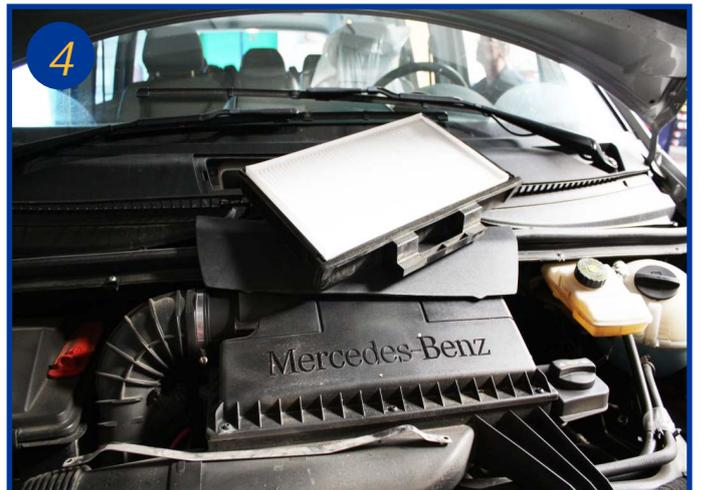
Remplacer l'élément filtrant usagé. Le remontage s'effectue dans l'ordre inverse du démontage.
