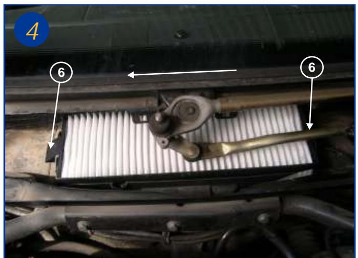
Procéder au changement de celui-ci en le faisant coulisser dans le sens de la flèche, replacer les 2 vis de fixation (repère 6). Le remontage s'effectue dans l'ordre inverse du démontage.
