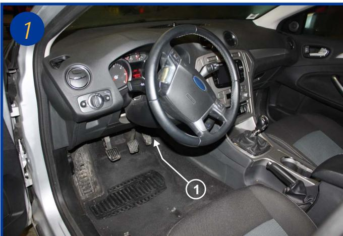
Le filtre d'habitacle est situé à l'intérieur du véhicule côté conducteur, sous le tableau de bord à côté de la pédale d'accélérateur (1).
