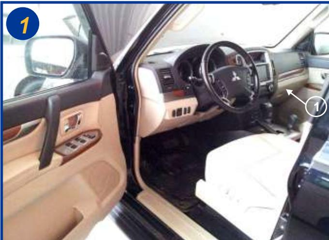
Le filtre d'habitacle est situé à l'intérieur du véhicule, côté passager derrière la boîte à gants (1).
