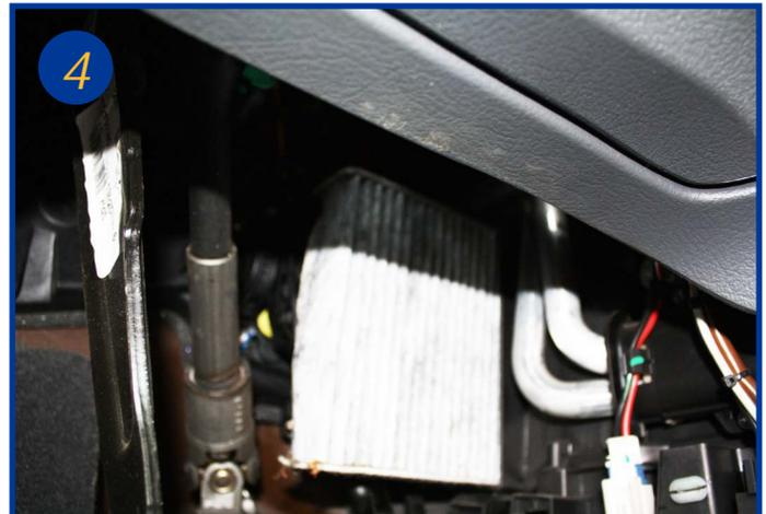
Extraire le filtre usagé et le remplacer. Le remontage s'effectue dans l'ordre inverse du démontage.
