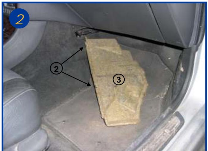
Dévisser les deux vis cruciformes (flèche 2) et retirer le cache (3) situé sous la boîte à gants.
