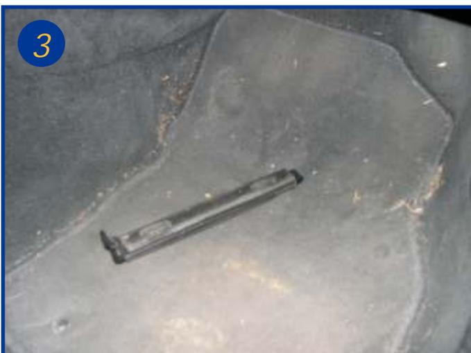
Déclipser le couvercle du boîtier filtrant et le retirer
