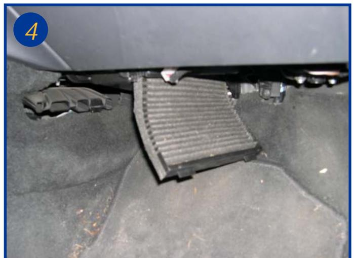
Extraire l'élément filtrant par le bas en le pliant légèrement
