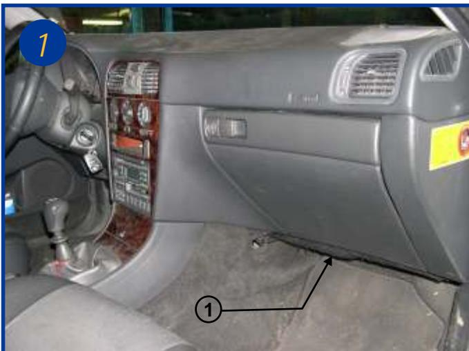
L'élément filtrant est situé dans l'habitacle du véhicule coté passager sous la boîte à gants (voir flèche 1).
