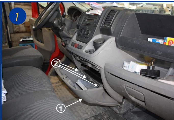
Le filtre d'habitacle est situé à l'intérieur du véhicule derrière la boîte à gants au centre (1). Ouvrir la boîte à gants et dévisser les 3 vis torx (2).
