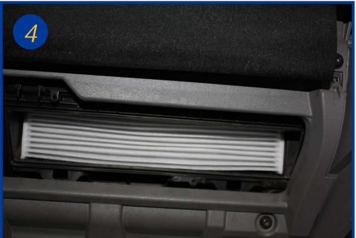
L'élément filtrant est placé verticalement, l'extraire par le bas. Le remontage s'effectue dans l'ordre inverse du démontage.
