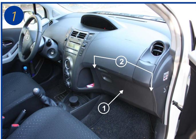
Le filtre d'habitacle est situé à l'intérieur du véhicule, côté passager derrière la boîte à gants (1). Ouvrir la boîte à gants et dégager les arrêts à droite et à gauche du tiroir (2).
