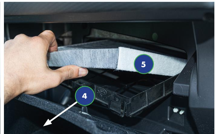
4. Sortir le tiroir de l'élément filtrant (4) et insérer un nouvel élément dans le logement (5). Le remontage s'effectue dans l'ordre inverse du démontage.
