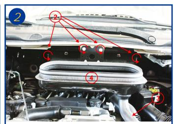
Dévisser les 4 écrous de 10 (2) Retirer la durite de son support (3). Sortir le bloc complet de ventilation (4).
