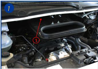
Le filtre d'habitacle est situé sous le capot moteur au centre sous labaie de pare-brise (1).
