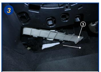
Pour ouvrir le couvercle du boîtier filtrant, le faire coulisser à l'aide de la poignée (3) dans le sens de la flèche.
