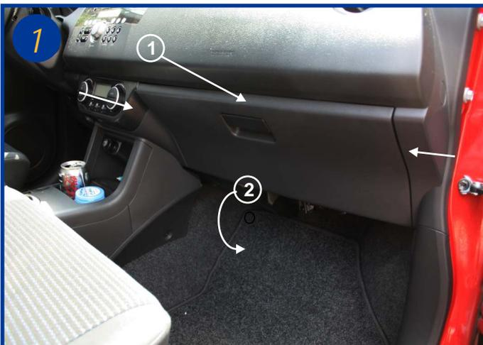
Le filtre d'habitacle est situé à l'intérieur du véhicule, côté passager derrière la boîte à gants (1). Ouvrir cette dernière (2) et presser sur les flancs du tiroir dans le sens des flèches pour dégager les butées arrêtoirs.
