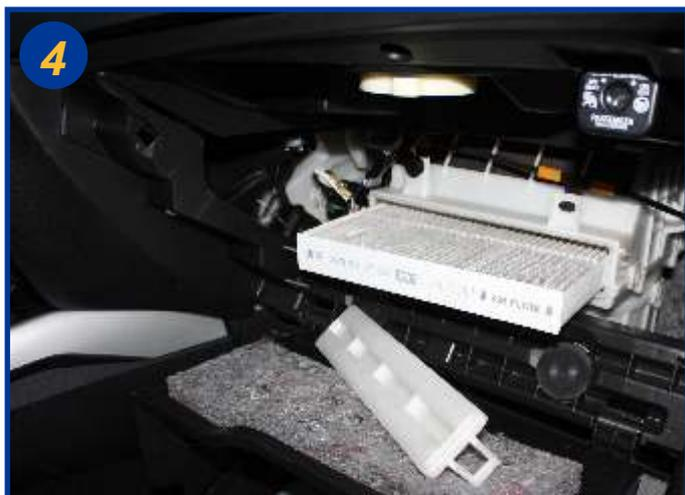
Extraire l'élément filtrant usagé en le sortant du boîtier et procéder à son remplacement.
