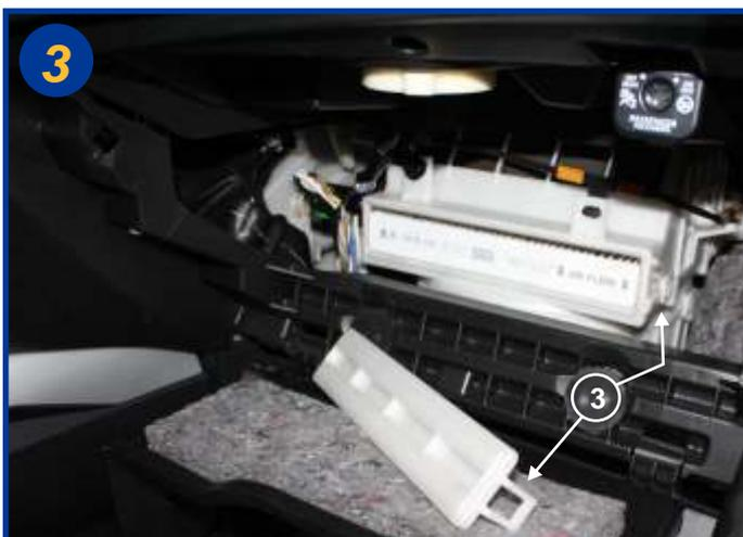
Ecarter les pattes de fermeture du boîtier filtrant aux 2 extrémités (3) et retirer le couvercle de celui-ci.
