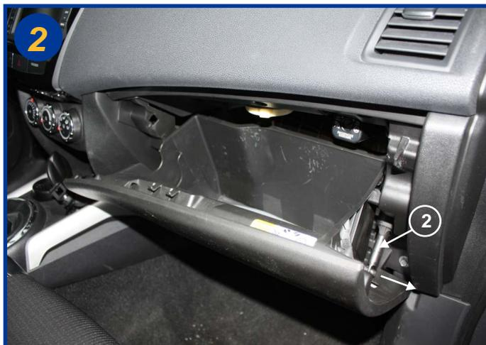
Désaccoupler l'amortisseur de boîte à gants (2) en tirant sur la base de celui-ci (voir flèche), puis presser sur les flancs du tiroir de la boîte afin de dégager les arrêtoirs et basculer l'ensemble vers le bas.
