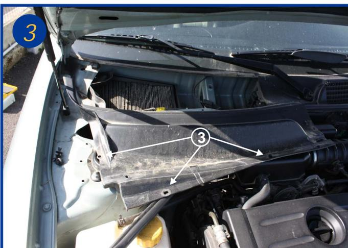
Retirer à l'aide d'un tournevis plat les 3 clips plastique (3) et enlever le carter totalement.
