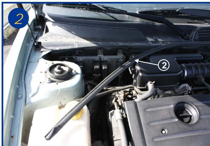
Déclipser sur la moitié le joint d'étanchéité du capot moteur (2).
