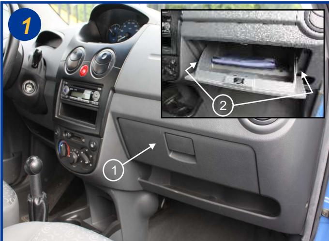
Le filtre d'habitacle est situé à l'intérieur du véhicule, côté passager derrière la boîte à gants (1). Ouvrir la boîte à gants (encadré) et dévisser les 2 vis cruciformes (2).
