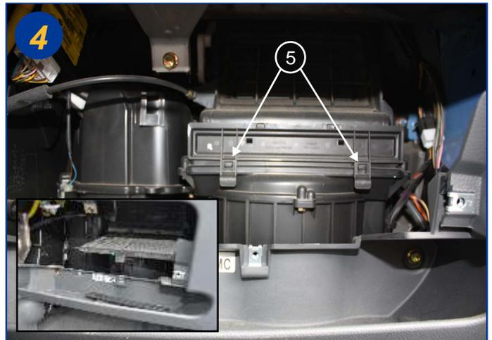
Agir sur les fermoirs du couvercle (5) en faisant levier pour extraire le filtre usagé et le remplacer (encadré). Le remontage s'effectue dans l'ordre inverse du démontage.
