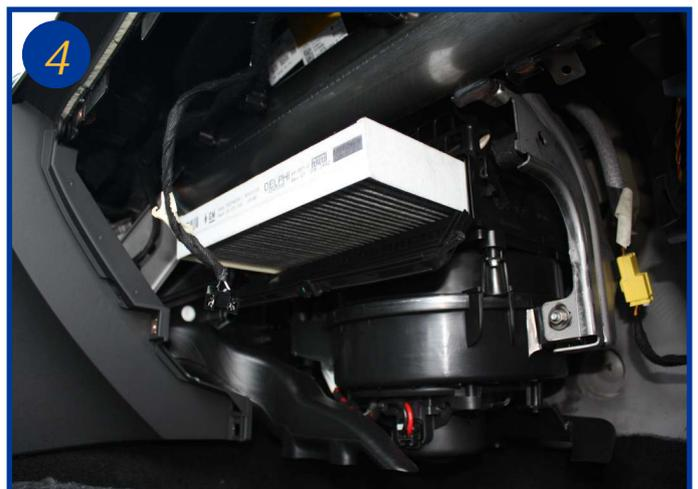
Extraire l'élément filtrant usagé et procéder à son remplacement. Le remontage s'effectue dans le sens inverse du démontage.
