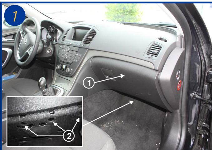
Le filtre d'habitacle est situé à l'intérieur du véhicule, coté passager derrière la boîte à gants (1). Retirer les 3 clips plastique (voir encadré (2)) sous la boîte à gants et déposer le carter souple.
