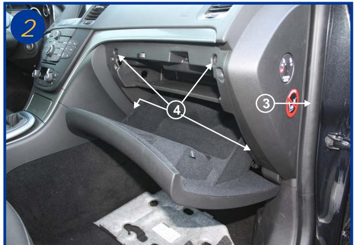
Ouvrir la boîte à gants. Dégrafer le carter (3). Dévisser ensuite les 4 vis de 7 (4) et extraire le bloc boîte à gants en prenant soin de débrancher la connectique de l'éclairage (voir photo 3 (5)).
