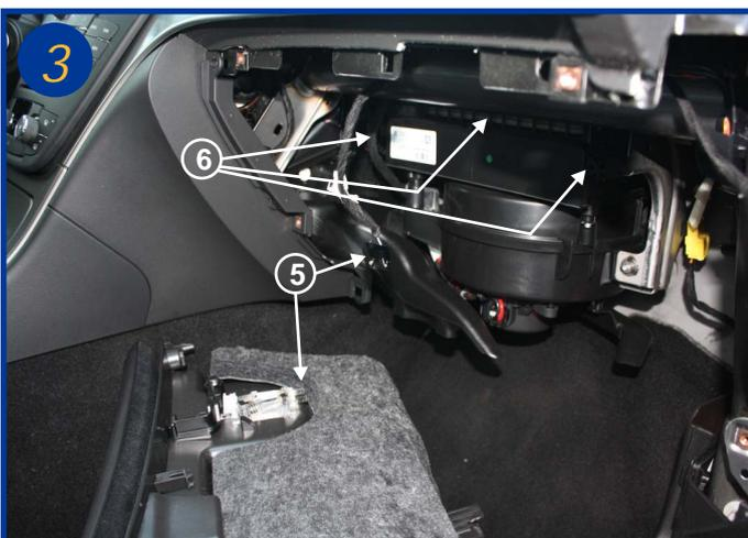
Agir sur les 3 fermoirs plastiques (6) et basculer le couvercle du boîtier filtrant vers le bas.
