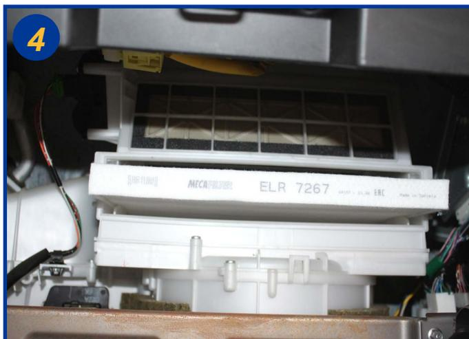
Retirer l'élément filtrant usagé et procéder à son remplacement.
