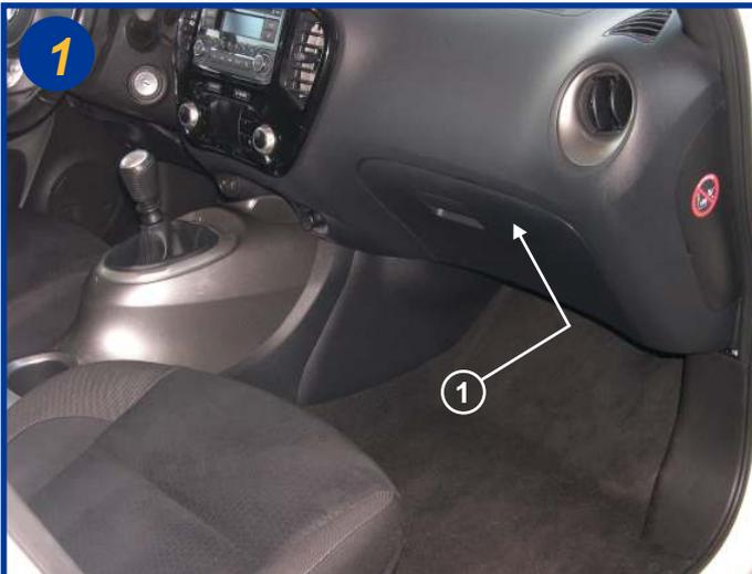
Le filtre d'habitacle est situé à l'intérieur du véhicule, côté passager derrière la boîte à gants, côté console centrale (1).
