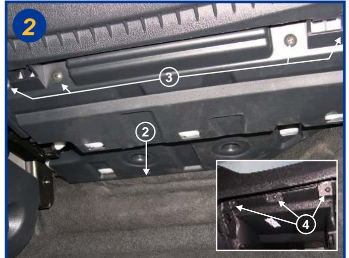
Sous la boîte à gants, dégrafer tout d'abord le carter (2), puis dévisser les 4 vis cruciformes (3). Ouvrir la boîte à gants et dévisser les 3 vis cruciformes (4 voir encadré)
