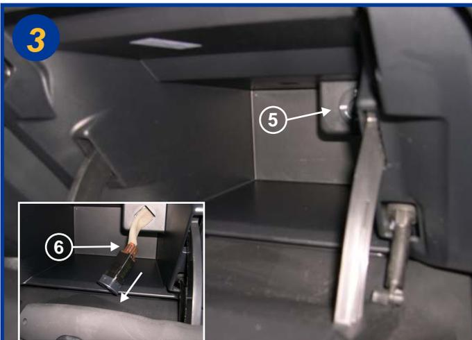
Mettre le commutateur Airbag sur la position off (5), le sortir de son logement (encadré) et le déconnecter en retirant la cosse (6). Extraire dans sa totalité le bloc boîte à gants.
