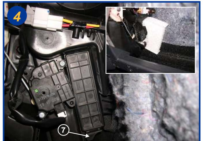
Repérer le couvercle du boîtier filtrant et l'ouvrir par le dessous (7). Retirer le filtre usagé en le déformant. Le remontage s'effectue dans l'ordre inverse du démontage.
