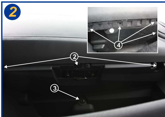
Dévisser les 3 vix Torx (T20) (2) puis la vis BTR de 5(3). Dévisser également les 4 visTorx (T20) (4) situées sous la boîte à gants (voir encadré). Retirer dans sa totalité le bloc boîte à gants.
