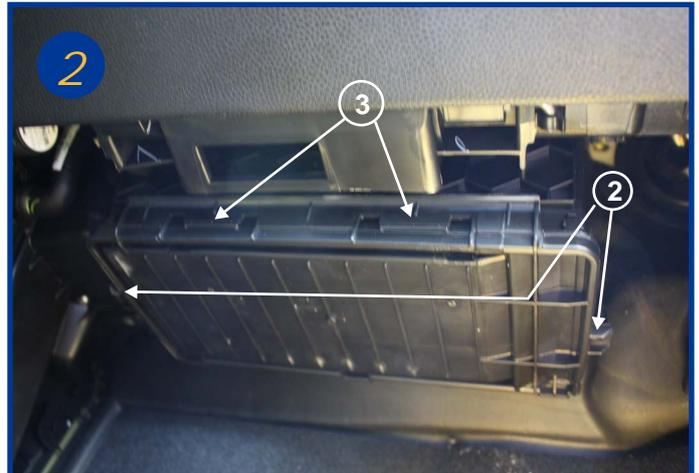
Pour retirer le couvercle, il faut tout d'abord retirer les 2 vis (2) (attention certains véhicules ne sont pas équipés de ces vis), puis faire sortir légèrement les 2 pattes (3) afin de basculer le couvercle vers le bas ce couvercle est muni d'une charnière derrière.
