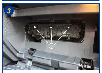
Le boîtier filtrant s'ouvre par le haut en actionnant les 3 languettes (3). Retirer la trappe d'ouverture.
