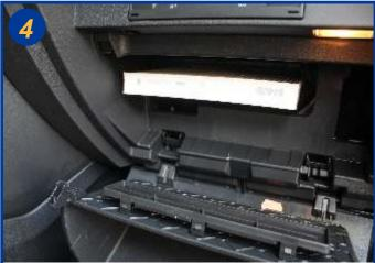
Sortir le filtre usagé et le remplacer. Le remontage s'effectue dans l'ordre inverse du démontage.
