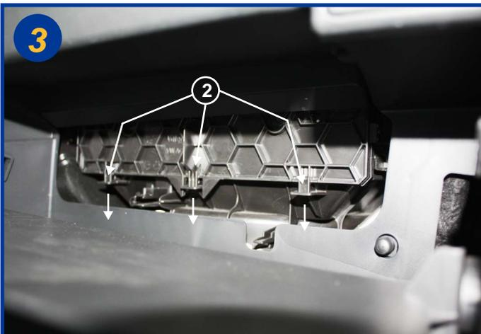
Ouvrir le boîtier filtrant en appuyant sur les 3 loquets (2) situés sur la partie inférieure du couvercle. Retirer le couvercle.
