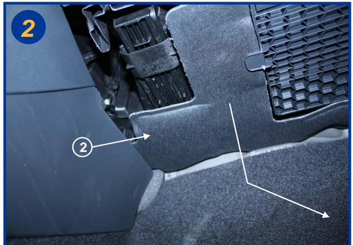
Retirer partiellement le carter souple (2) et le mettre sur le côté.
