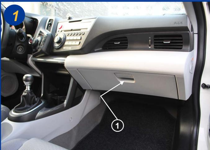
Le filtre d'habitacle est situé à l'intérieur du véhicule, côté passager dans le fond de la boîte à gants (1). Ouvrir la boîte à gants.
