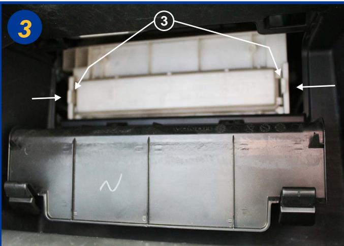
Ouvrir le boîtier filtrant en appuyant sur les fermoirs (3) dans le sens des flèches.
